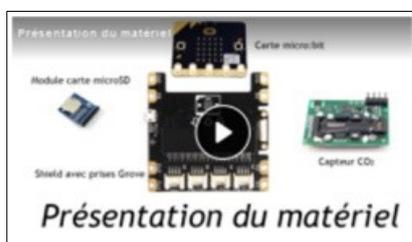
" Comment mesurer la concentration en CO2 à l'aide d'un microcontrôleur muni d'un capteur, sans avoir à écrire de lignes de codes ? Ce type d'expérimentation pourrait par exemple s'utiliser dans le cadre du projet expérimental et numérique en enseignement scientifique en classe de première". Stanislas Dorey montre comment faire avec une carte microbit et une carte contrôleur. [Sur le site](#)
